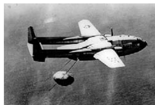
Ombyggda Fairchild C-119 "Flying boxcar" användes för att i luften med en "håv" fånga kamerakapslar som sjönk mot land eller hav under en fallskärm.
