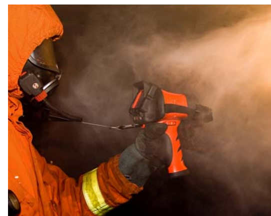
Med hjälp av kameran kan man se både i mörker och tät rök.
