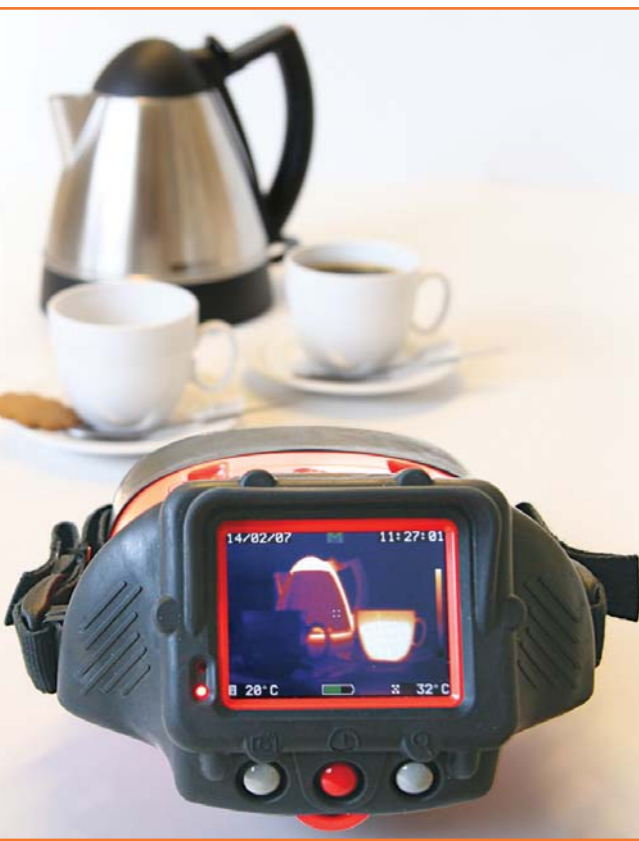
Bara den högra koppen innehåller varmt kaffe. Värmestrålningen från koppen syns tydligt på värmekamerans LCD-skärm.
