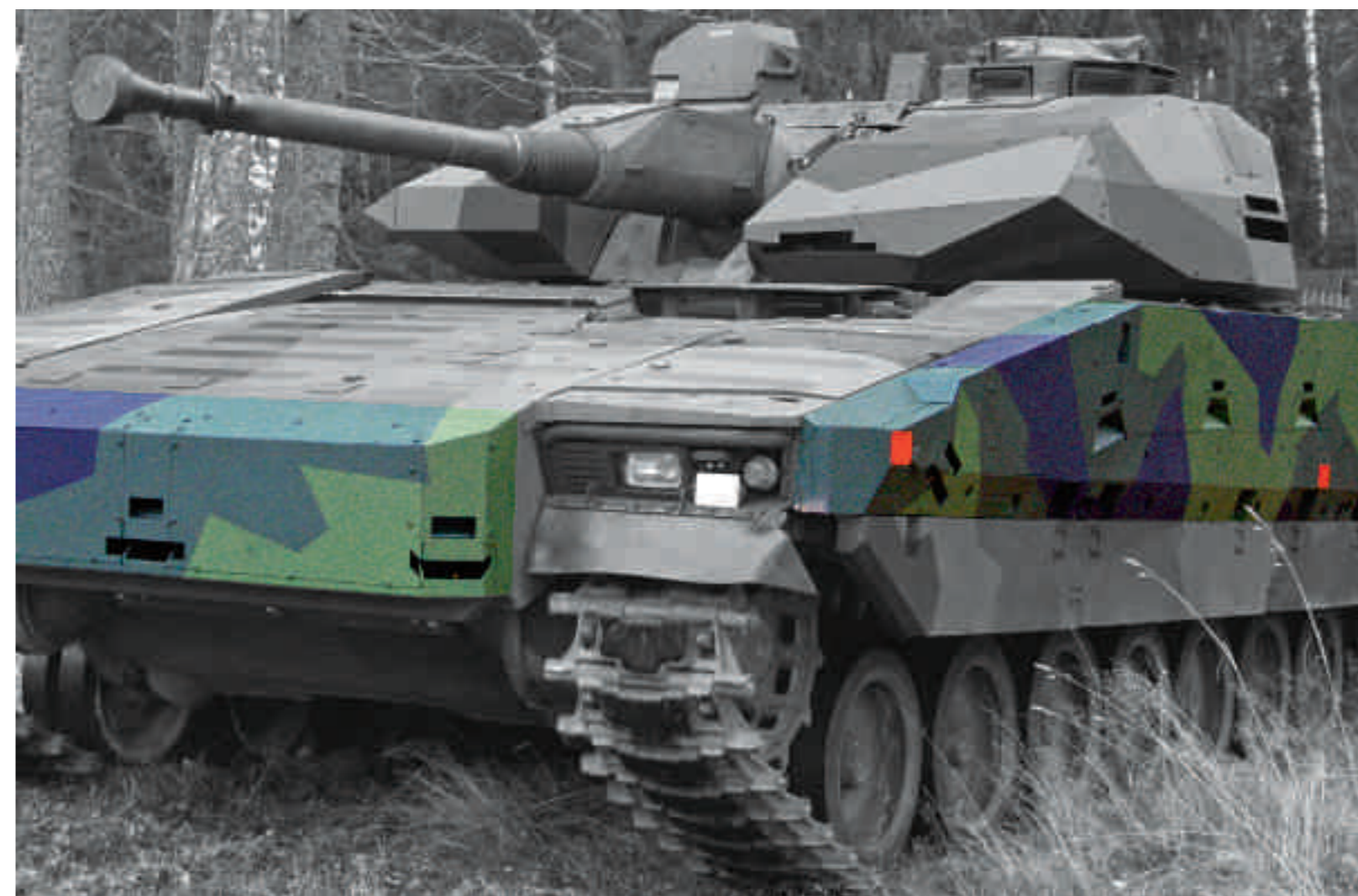
För ett otränat öga ser AAC-demonstratorn nästan ut som ett vanligt Stridsfordon 90. Att det rör sig om ett AAC-fordon avslöjas dock av utbuktningar på fordonets sidor och i dess front. Dessa döljer bland annat sensorer och motmedel. Systemet, vars förkortning utläses active armour concept, kan både känna av att en fiendtlig projektil är på väg, samt skicka ut motmedel som förstör den. Bilden är färgmanipulerad.
