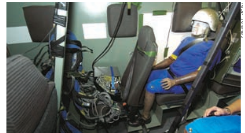
Patrik Persson och Gustav Pettersson, från civilingenjörsprogrammet Medieteknik vid Linköpings tekniska högskola, utför examensarbete på FMVs provplats i Karlsborg. Examensarbetet syftar till att ta fram nya metoder och utveckla ett specialanpassat programverktyg för mätningar i bilddata. Bilden visar en kontrollmätning för systemets hastighetsberäkningar med en dopplerradar som referenssystem. Till höger dopplerooperatör Carolina Johansson, som porträtterades i PROTEC 3/2005.
