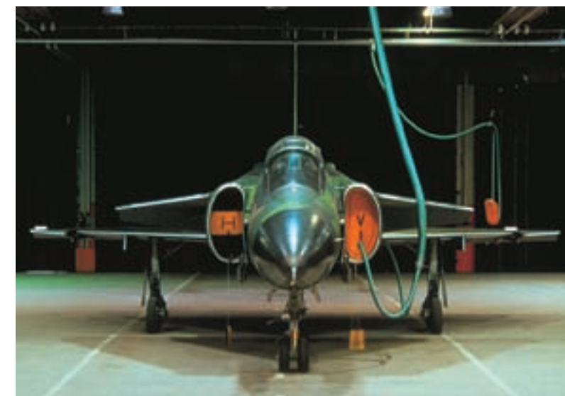
Sverige har varit föregångare när det gäller avfuktning av flygplan. MTBF, Mean Time Between Failure, är ett mått på hur ofta fel uppstår. På Viggen förbättrades dessa värden med 150% sedan planen började avfuktas.
