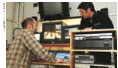
Torben Gustavsson och Lars-Ove Karlsson har hand om datorstyrda höghastighetskameror med digital bildlagring. Kamerorna kan ta upp till 120.000 bilder per sekund. Med hjälp av referenspunkter på fordon som sprängs görs digitala 3D-modeller av fordonet och förloppet. Då kan explosionen och dess verkan studeras från alla tänkbara vinklar.
