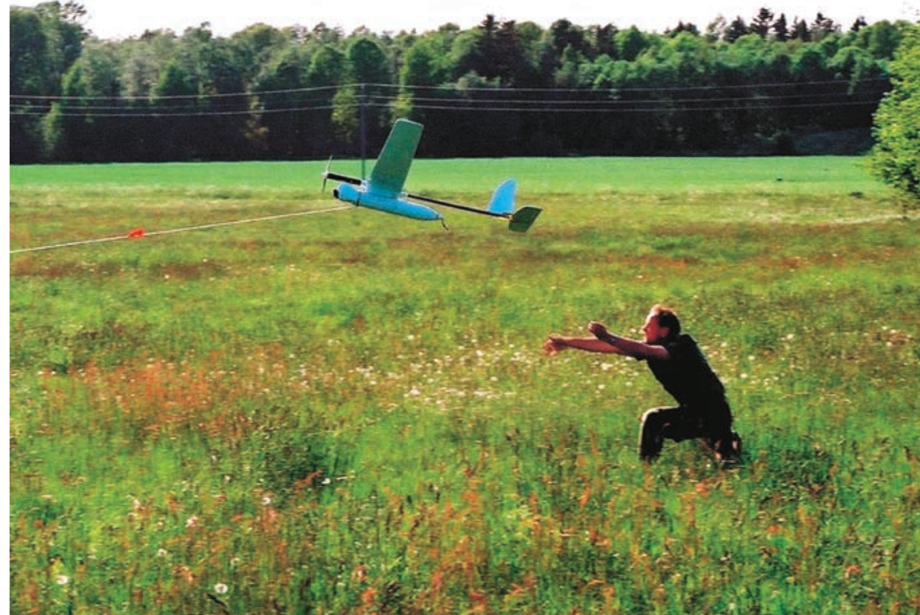
UAVn Skylark är liten och drivs av en elmotor. I luften är den nästan omöjlig att upptäcka genom syn eller hörsel.
