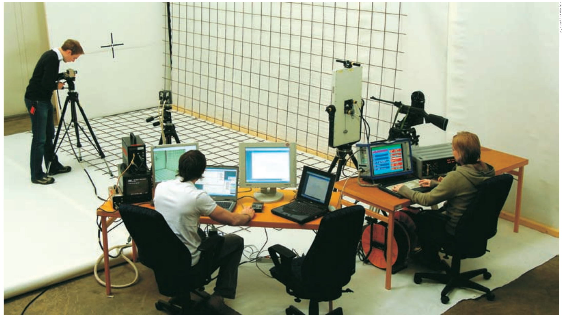
Patrik Persson och Gustav Pettersson, från civilingenjörsprogrammet Medieteknik vid Linköpings tekniska högskola, utför examensarbete på FMVs provplats i Karlsborg. Examensarbetet syftar till att ta fram nya metoder och utveckla ett specialanpassat programverktyg för mätningar i bilddata. Bilden visar en kontrollmätning för systemets hastighetsberäkningar med en dopplerradar som referenssystem. Till höger dopplerooperatör Carolina Johansson, som porträtterades i PROTEC 3/2005.
