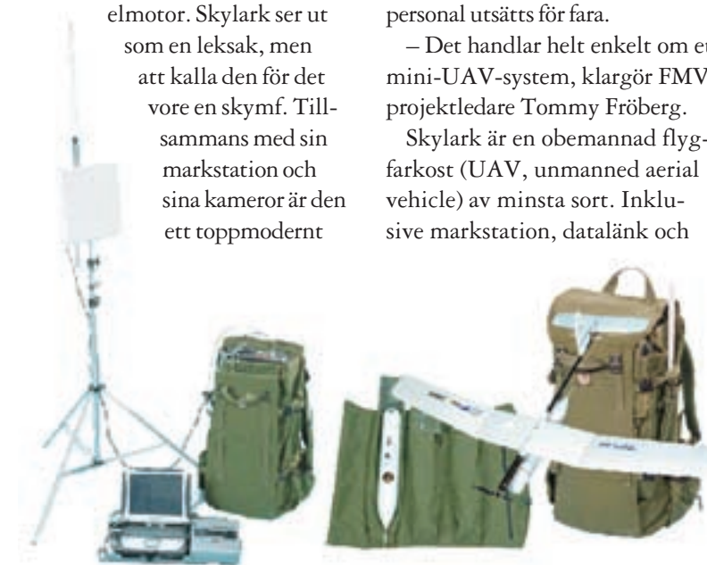
I mini-UAV-utrustningen ingår från vänster: datalänkantenn, operatörskonsol, markstation (i rygsäck), avionikkapsel (i fodral), själva farkosten samt dess rygsäck.
