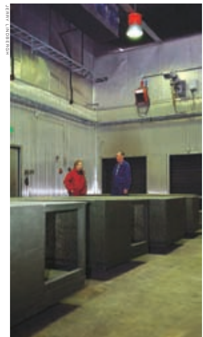
Klimathallen erbjuder temperaturer mellan -52° och +63° samt kontrollerad humiditet.
