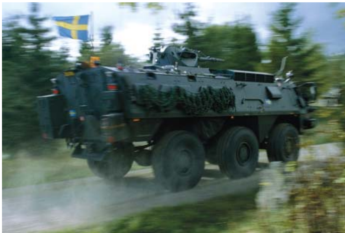
23 ton i full fart. Pansarterrängbil 203 är en både bekväm och snabb landsvägsvagn. 95 km/h är toppfarten.
