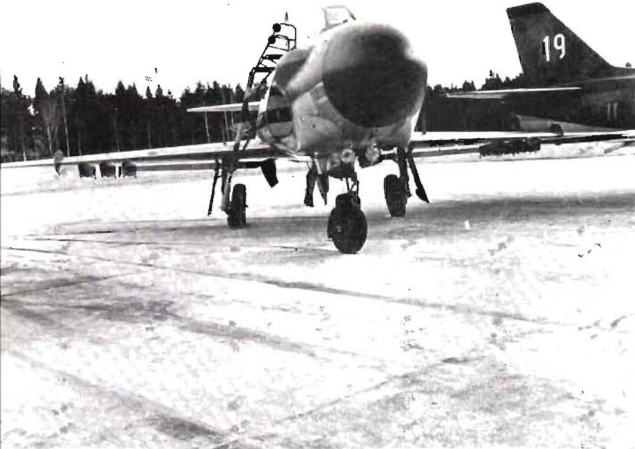
Den 15 dec förra året inträffade följande incident på F 11. — Föraren av en S 32 C körde efter slutförd flygning in bakom "flygplanlinjen" på 5:te kompaniets platta. Vid högersväng för parkering gled flygplanet på tvären in mot en annan 32:a på parkeringslinjen. Föraren som inte hade observerat den befintliga banisen under rimfrosten hade alltså ej avpassat farten därefter. (Se fig 1, föregående sida.) Det påkörda flygplanet erhöll skador på höger skevroder och höger vingspets, medan den sladdande 32:an fick en buckla på vänster vingframkant. (Se fig 2 och 3.)
