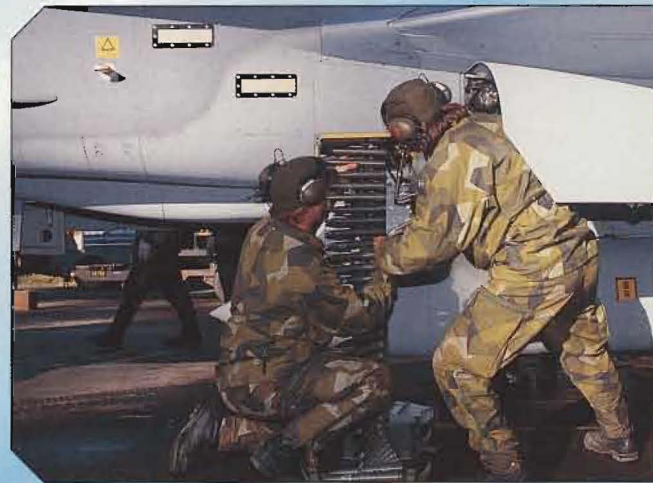
Gripens automatkanon laddas av klargöringstroppen.
