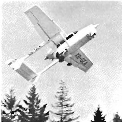
o Ovan: VAK 191 B (mockup) tysk motsvarighet till det engelska VTOL-flygplanet Harrier. Nedan: En intressant och behaglig STOL-skapelse, Robertsons konverterade Cessna 337 Super Skymaster. Tvåmotorigt (drag och påskjut) och sexsitsigt affärs/trp-flygplan som först i Europa lancerades av pumpstillverkaren Stenberg-Flygt AB. Bofagets förste pilot är Nils-Bertil Kronström — sprungen från FV.
