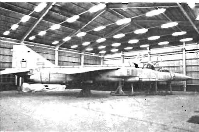
● Tv: Japans första överlydsjet-skolflygplan, Mitsubishi XT-2 i mock-up. "Lustigt" lik Jaguaren, n'est-ce pas? Maxfart och -höjd Mach 1,6 resp 15.240 m. Längd 17 m. Vikt 8,16 MT. Landningssträcka 1.524 m.
