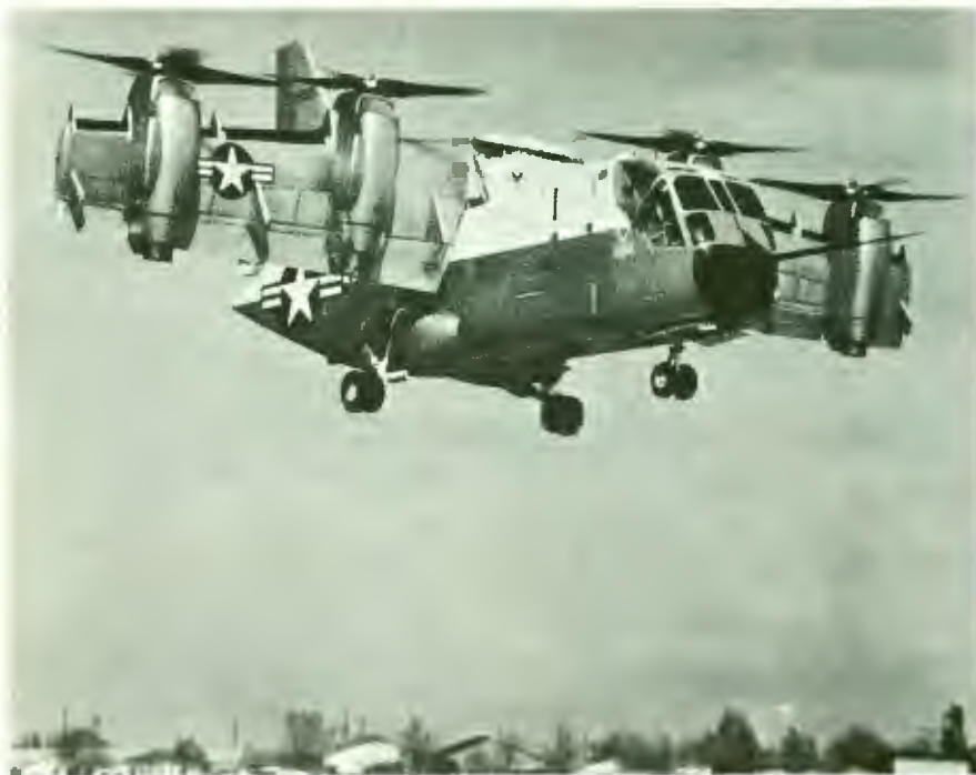
Ling-Temco-Vought-XC-142A — fyrmotorigt amerikanskt V/STOL transportplan, som under uppvisningsdagarna gav utmärkta prov på hovring, vertikal start och konventionell landning.
