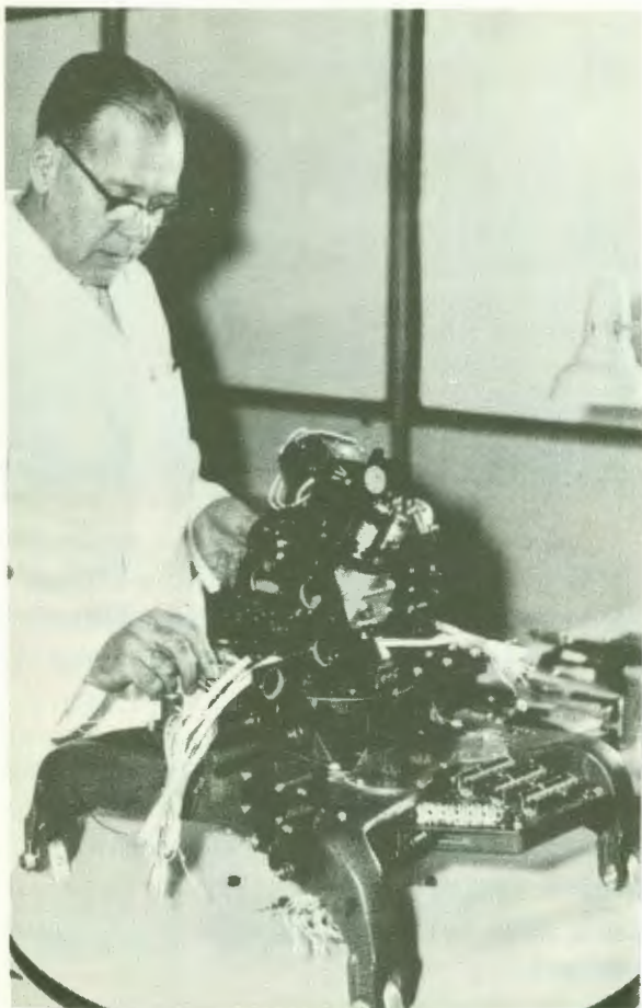
Montering av radarantenn
