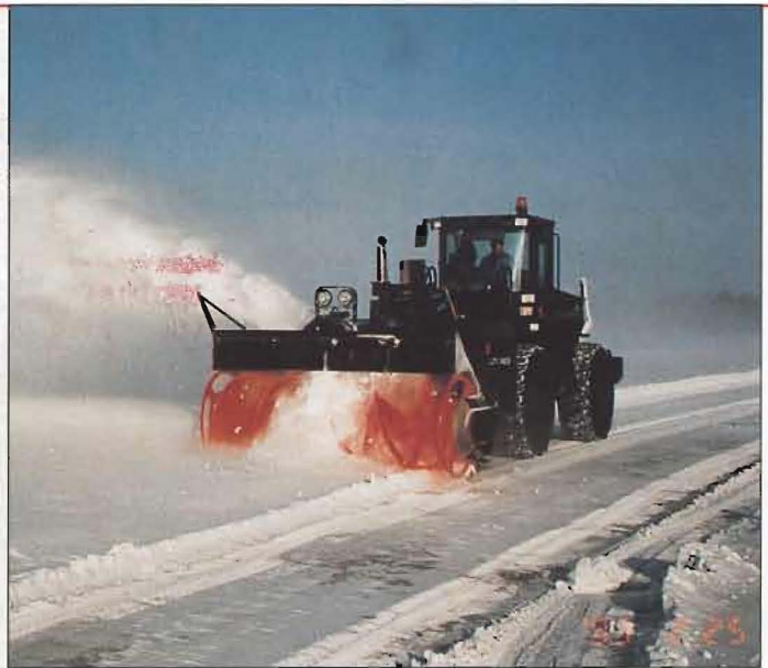
Utan en effektiv fälthållning skulle våra flygbaser snabbt bli omöjliga att använda. Vintertid är det viktigt att snabbt få undan snö och is. För snöröjning används bl a denna nya typ av hjullastaren snöslunga.
