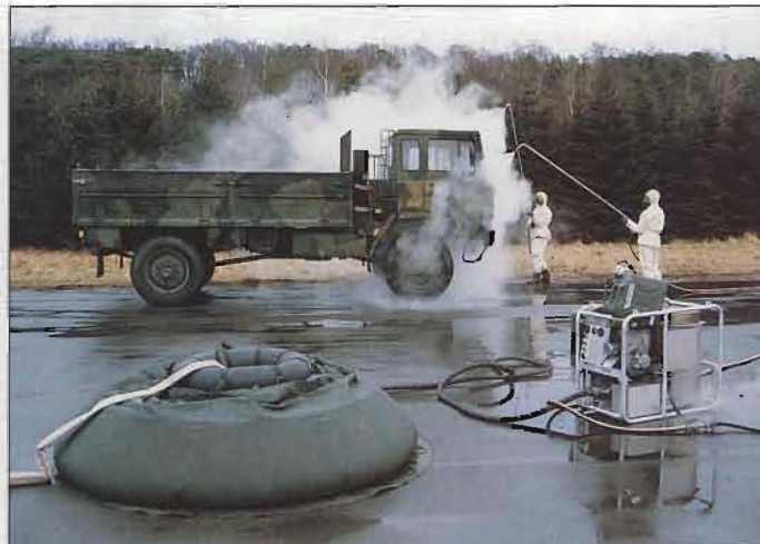
Efter anfall med C-stridsmedel är det viktigt att snabbt kunna sanera fordon och utrustning. Även enkla metoder, som här sprutning med hetvatten, ger god effekt.
