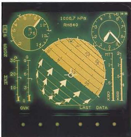
Flyginformationsmod på FI (flygdata-indikator) med bl a ett elektroniskt ritat klot.
