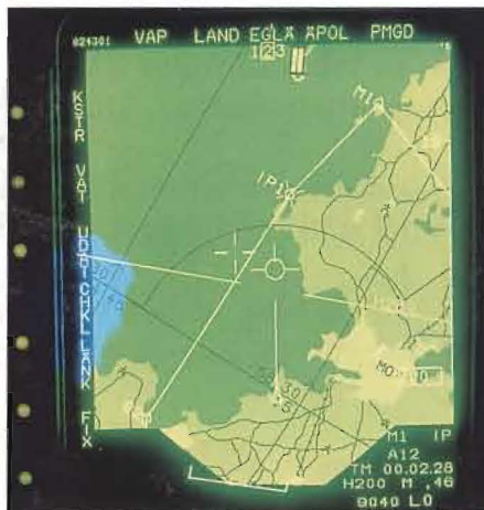
På TI (taktisk indikator) väljer piloten normalt taktisk information som läggs över den digitala kartan, som har flera skolor.
