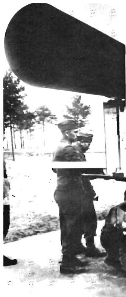
Hitlers första hemliga vapen — V 1:an. En flygplanliknande, självgående robot, en "flygande bomb". Maxfart ca 600—650 km/tim, medförd sprängladdning ca 1 ton, "skottvidd" (flygsträcka) ca 300 km. Insattes mot
