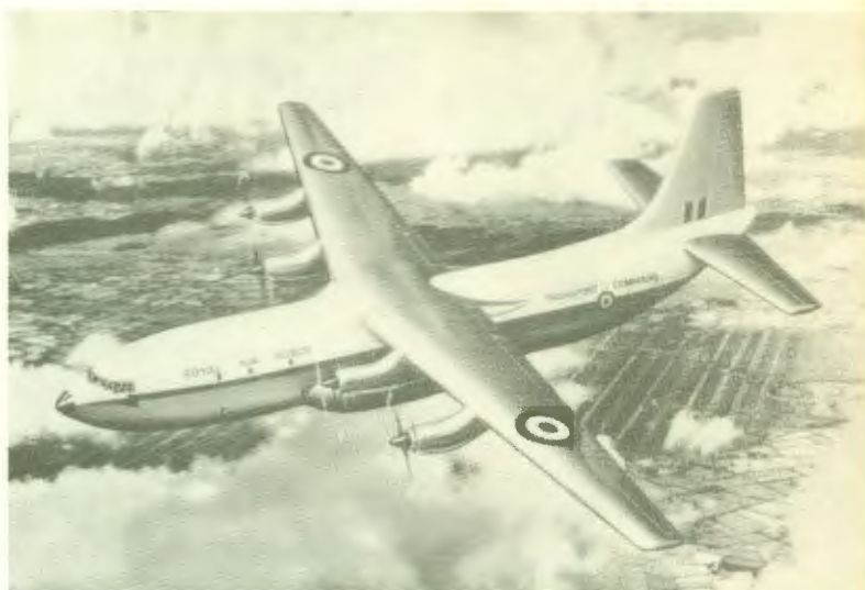
SHORT BELFAST. Royal Air Force har beställt 10 strategiska transportflygplan av den typ som hittills kallats Britannic. Modellen är nu om döpt till Belfast. 4 Rolls Royce Tyne turbopropmotorer svarar för dragkraften. En taktisk version planeras med en utveckling av Tyne-motorn som ger 9.500 hk.
