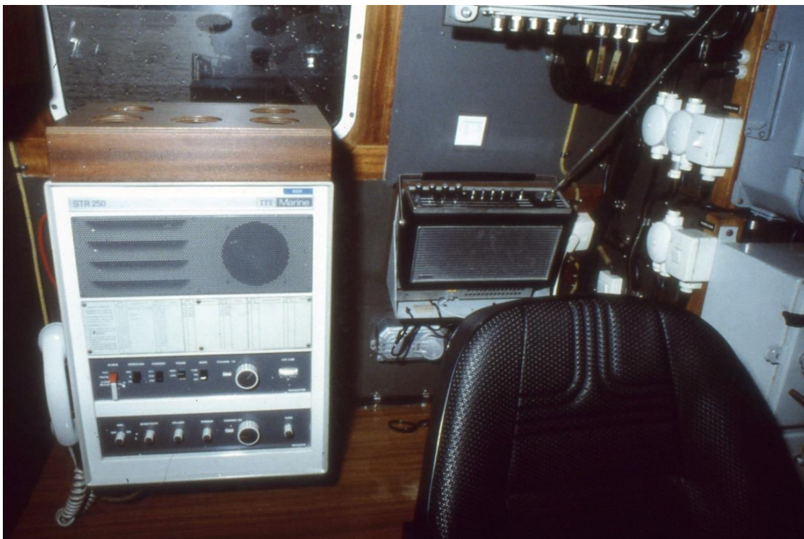
86. Minsvepare typ fiske. Luför/lv-ordermottagare och kortvågsstation
