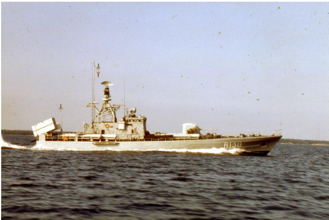
36. Robotbåt typ Norrköping
