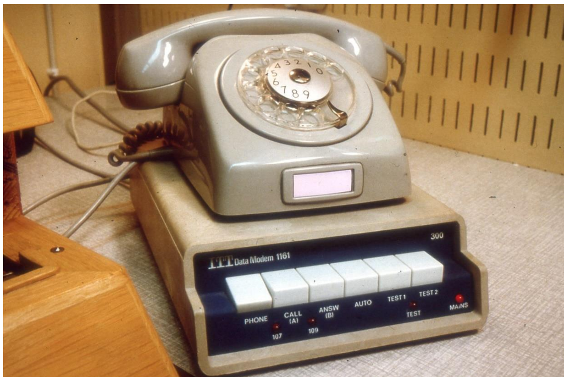
123. Sambandscentral. Närbild på modem
