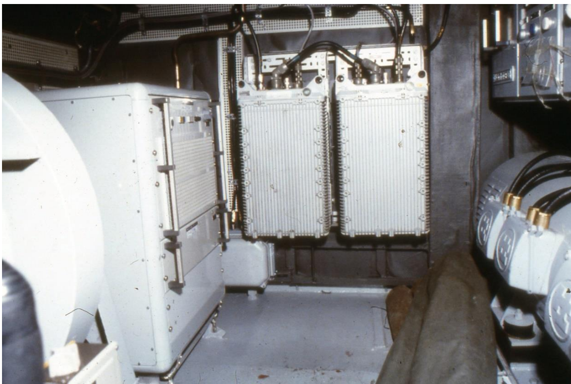
43. Rbb typ Norrköping. RA 800 och SÄ 844 i apparatrum akter om bryggan
