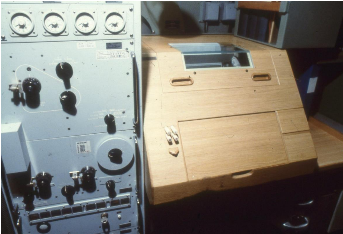
15. Ub typ Näcken. Radiohytt, kortvågssändare och fjärrskrift
