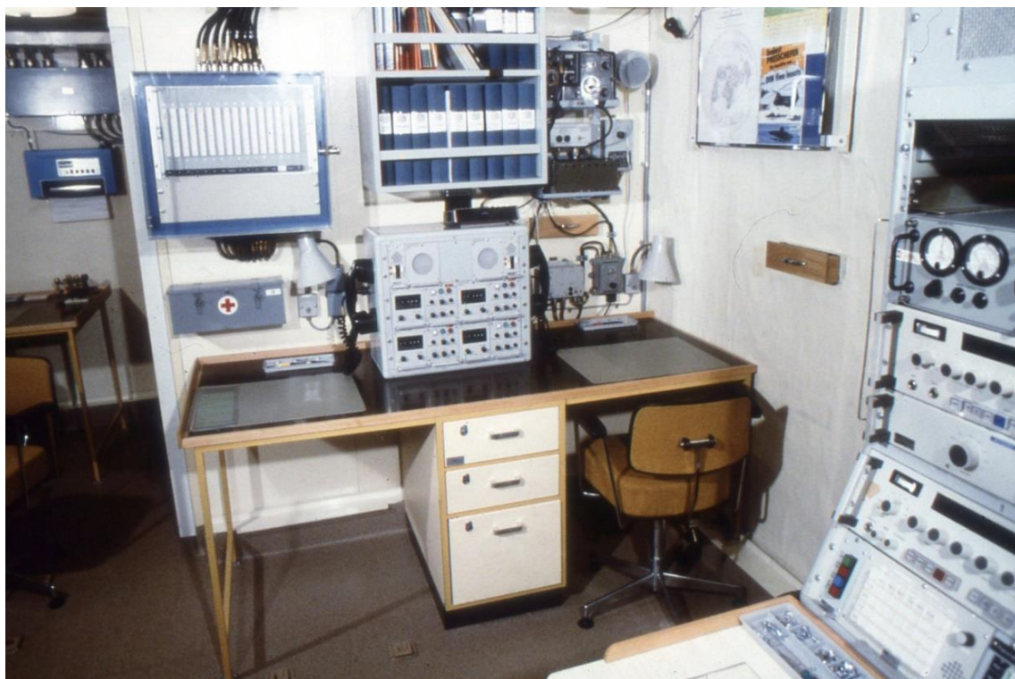
65 Minfartyg typ Carlskrona. Radiohytt A, översikt höger, huvudstativ och UK-plats
