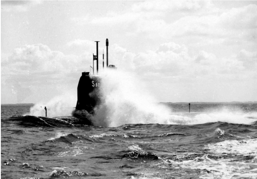
Sjöormen – kortvågsantennen har den horisontella plattan (Bengt Rasin)
