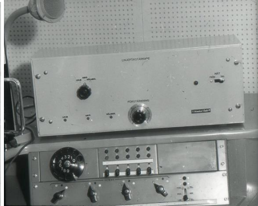
148. Manöverenhet för MRX-15 ovanpå denna linjeförstärkare A3-modulering (Standard Radio).
