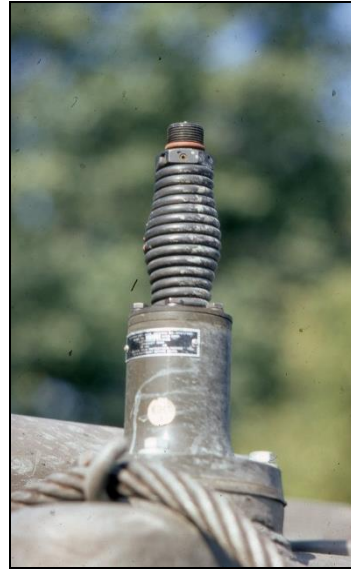
605. Antennfäste för fordon/båt, böjbart
