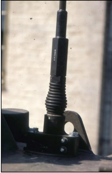
604. Antennfäste för fordon, böjbart
