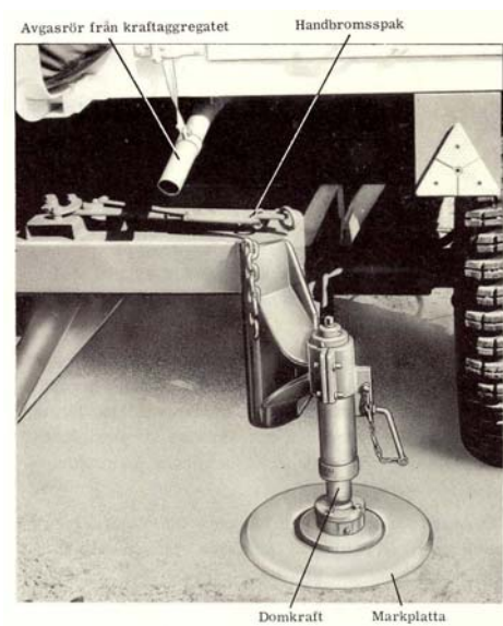
Bild 8. En av de främre domkrafterna i nedfällt läge (med markplatta).
