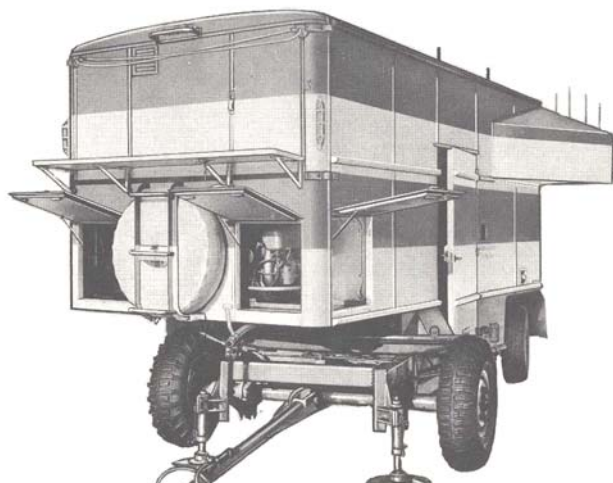
Bild 7. Transportvagnen med luckorna till kraftaggregatrummet öppnade.
