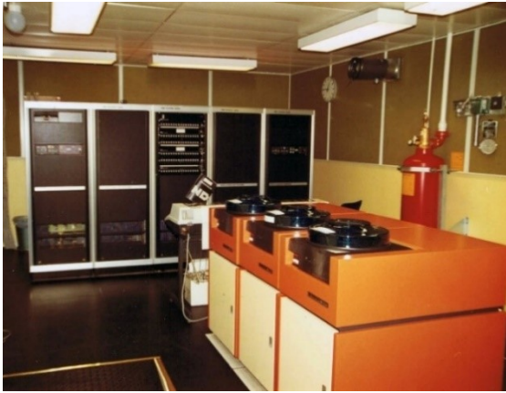
MFC V dator- och transmissionsrum. Till vänster Norsk Datas N-100 kabinett med device-switch i mitten. Till höger Siemens patch-stativ och telegraföverdrag. Korskopplingsstativ längst till höger.
