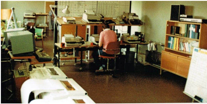
Operatörsrum UC Ost. Blivande MFC O betjäningsplats till vänster i bakgrunden. Till höger två Tandbergterminaler för kommunikation med Siemens 404.
