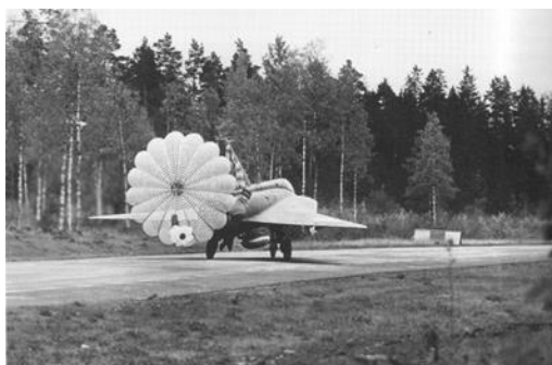
J35B ur F18 landar med Bromsskärm på vägbas i trakten av Heby.
