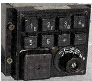
FR-21 ME2 med KV (knappar och vred) för val av STRIL-frekvenser och + knapp för automatsökning av 16 olika styrdatasändare. PP nere till vänster.
