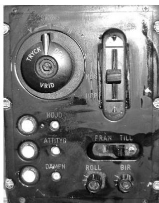
SA-05 ME med strömställare och styrreglage.
