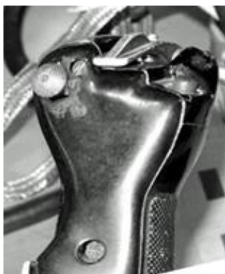
Styrspaken SS med Os-, Prep- och AVF-bygeln överst.
