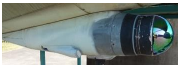
J35F2 framdel med IR-spanare 71N.
