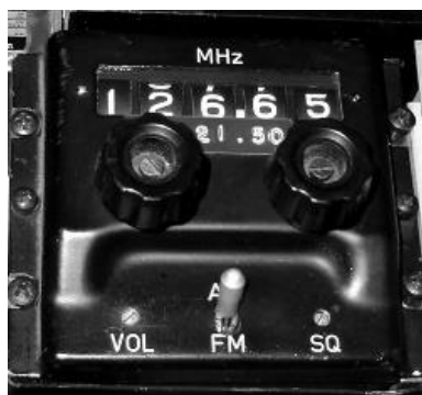
FR-21 ST med Frekvensväljarrattar vid manuellt val. Externa val gjordes från ME2.
