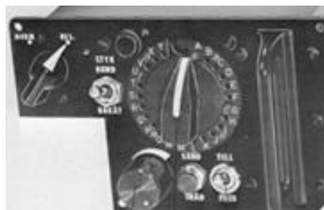
FR-13 ML med bland annat KV i mitten och Kanalförväljaren, "spaden" till höger.
