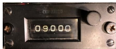
FHIS med höjdinställningsvredet till höger och siffror, inställd på 9000 meter.
