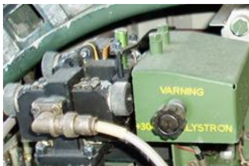
Mottagarens blandare och omställningsratt för reflexklystronen.
