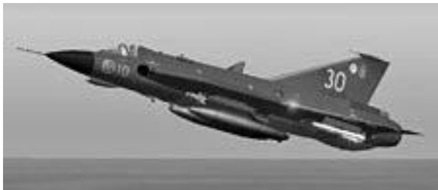
J35J med 2 RB27, 2 RB24J, 2 FT och IR-spanare.
