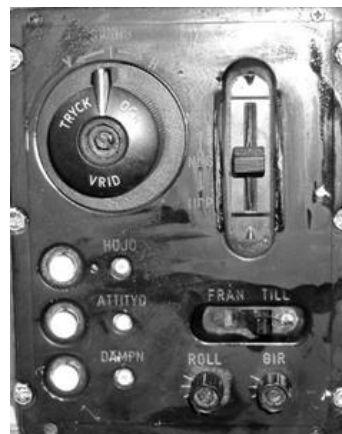
SA-05C ME med strömställare och styrreglage i J35D.
