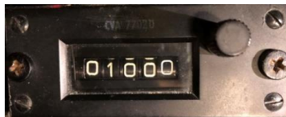
FHIS inställd på återflygningshöjden. I det här fallet 1000 meter.
