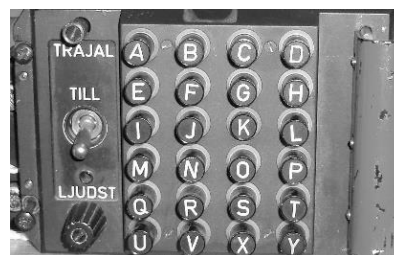
FR-17 ME med KV knappar Kanalförväljaren till höger.
