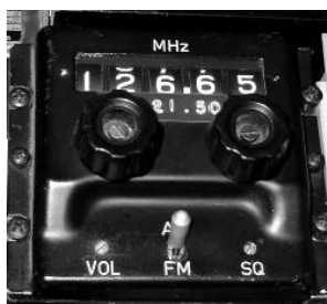
ST FR-21 med Frekvensväljarrattar sifferfönster, och övriga reglage.
