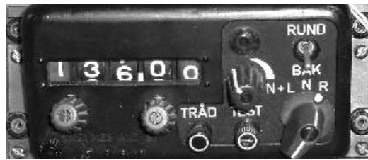
ME1 för manövrering av ST FR-28. ME3 för fjärrmanövrering av ST FR-21B i främre apparatrum.
