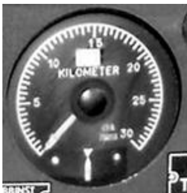
PN-50 Navigeringsinstrument visar avståndet 0 – 300 / 30 kilometer och sidvisaren riktningen till navigeringsfyren eller flygplanets läge i förhållande till QFU-EL (elektrisk).
