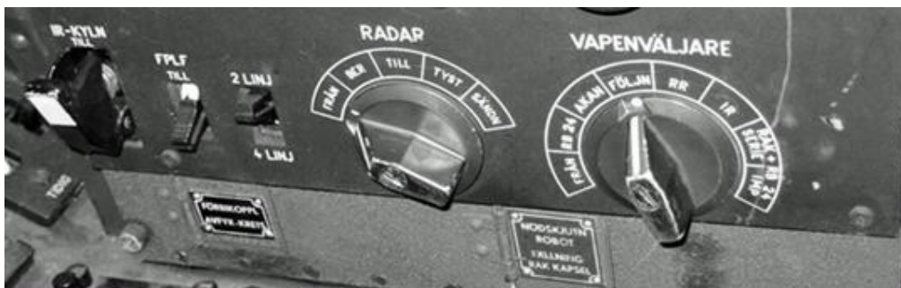
Vapenpanel VP med omkopplare och reglage, placerad till Höger i kabinen Anm. Panelen på bilden är en ombyggd J35F2-panel med ändrade vapenväljarlägen.
