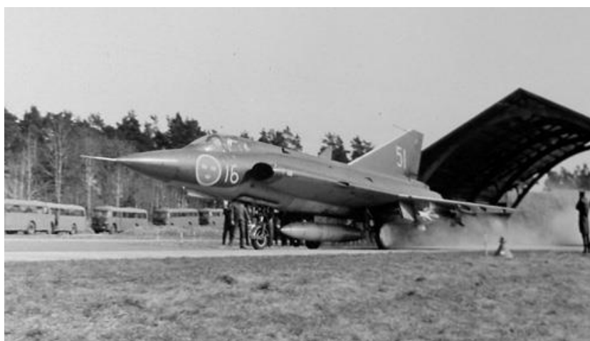
J35A med robotar RB24B och Fälltank FT ut ur beredskapsvärn med motorpådrag. Rotetvåan ut ur ett värn vid sidan om.
