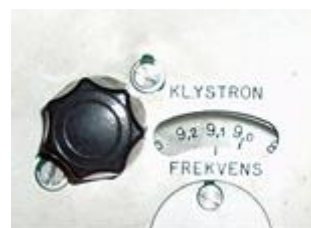
Klystronens omställningsratt och frekvensskala.
