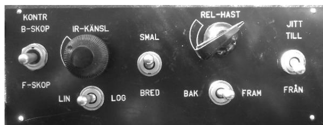
Radarpanel RP med omkopplare och reglage, placerad till vänster i kabinen.
