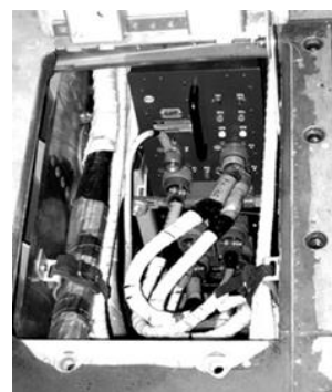
RB27/28 hjälppapparater för slaving och styrning från PS-01/011 och S-7B3/31 i vänster AKAN- och ammunitionsutrymme.
