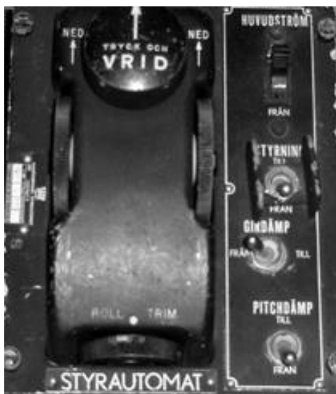
SA-051A MP med strömställare samt SA-051A ML med styrreglagen.
