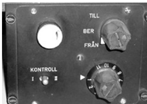
IK ML med FV, Kodväljaren, Testströmställare och Indikeringslampa.
