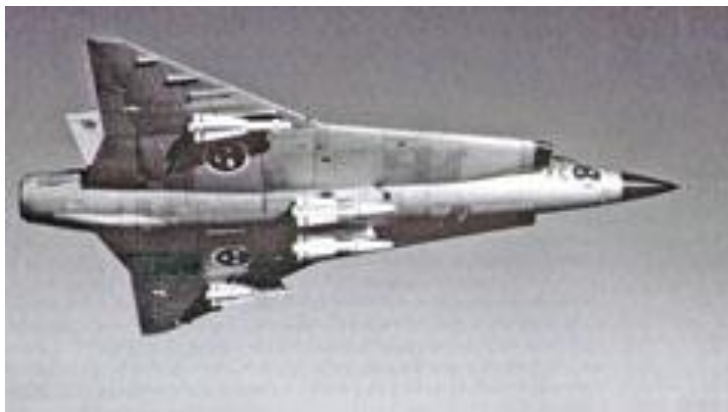
J35F i ursprungligt utförande med två RB27 under kroppen och två RB28 under vingarna från 1966.
