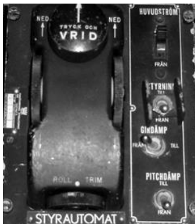
SA-51B MP med strömställare samt SA-051B ML med styrreglagen J35B.
