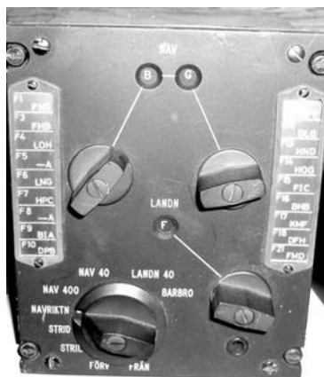
Fronten på PN-594 ML till navigeringsradar PN-594.
