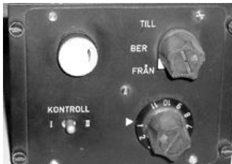
IK ML med FV, KV, Testströmställare och Indikeringslampa.
