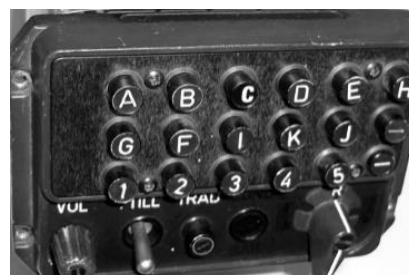
FR-21A / 21B ME1 med KV för STRIL i nedre raden vilka benämndes med siffror.
