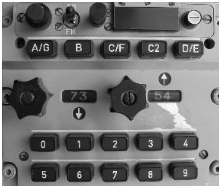
ME1 för manövrering av ST FR-28. ME3 för fjärrmanövrering av ST FR-21B i främre apparatrum.
