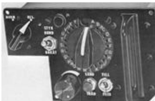
FR-13 ML med KV i mitten och Kanalförväljaren, "spaden" till höger.
