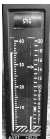
AHK-indikatorn med sina indikatorer, Höjd och Avstånd till Målet, Standardhöjd samt Kommandon.
