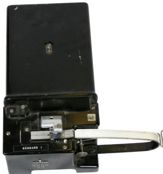
Bild 9. Remssändare 201 . Tillverkare: Siemens i Tyskland. Remssändare 201 med Siemens beteckning T Send 61 användes i första hand som sändare vid manuella fjärrskriftcentraler och hos abonnenter med hög belastning på avgående linjer, vid ÖB och MB stab. Remssändaren ersattes under mitten av 1960 -talet av remssändare 312 som tilldelades alla abonnenter ingående i försvarmaktens gemensamma fjärrskriftnät.
