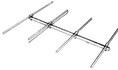
Bild 41 Yagiantenn, med löstagbara antennelement
