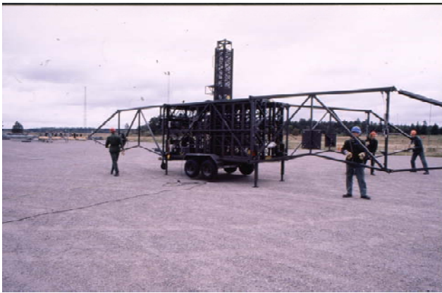
Bild 153 Upprättad Tp mast 35 m
