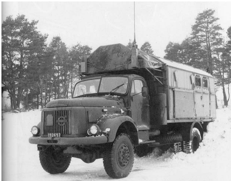
Bild 78 Sambandshytt monterad på Itgb 939
