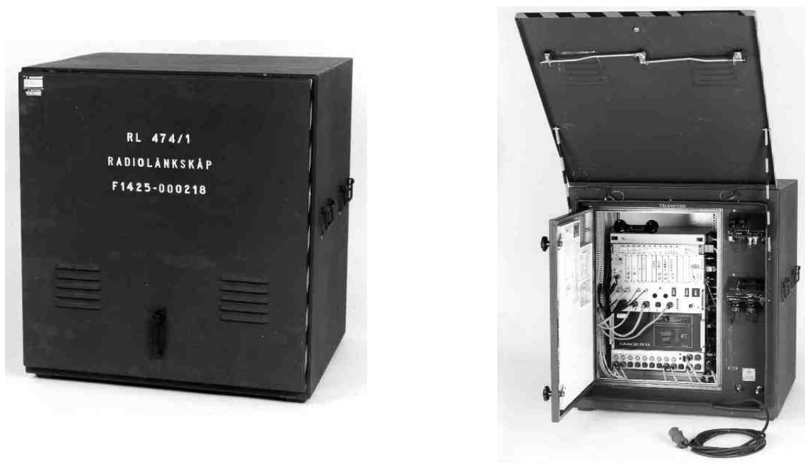
Bild 143 RL 474 inmonterad i radiolänkskåp
