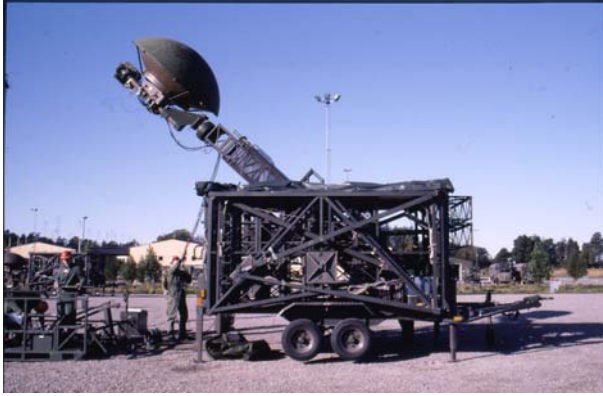
Bild 152 Upprättande av mast 35m
