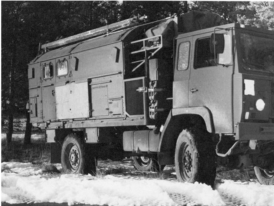
Bild 77 Radiolänkcentralhytt monterad på tgb 30
