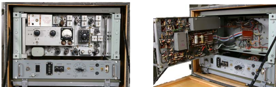
Bild 26 Sändare/mottagare sedd framifrån resp utsvängd
