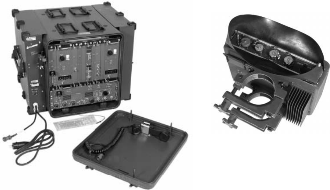
Bild 133 RL 74 med antennförstärkare
