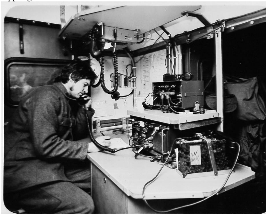
Denna bild visar en telefonist med en Ra 422 med en FK 3. Ovanför telefonistens huvud syns linjeväljarutrustningen LVA.
