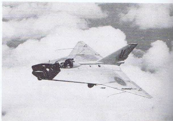
SAAB:s experimentflygplan "Draken", svensk flygindustris och flygvapnets första deltavinge, har väckt stor uppmärksamhet inte minst utomlands, där den betecknats som världens troligen mest "futuristisk" deltavinge.
