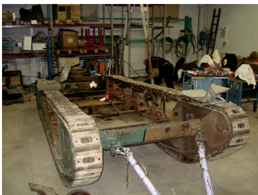
Så här ser chassiet och karossen ut när de är separerade.
