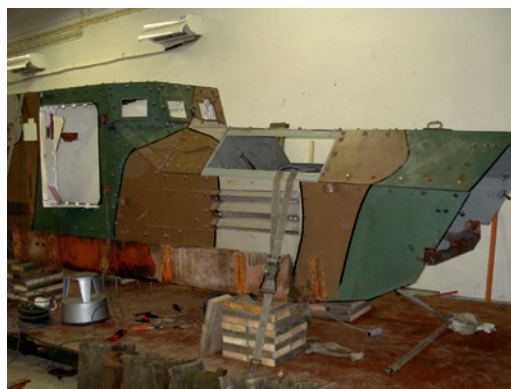
Så här ser chassiet och karossen ut när de är separerade.
