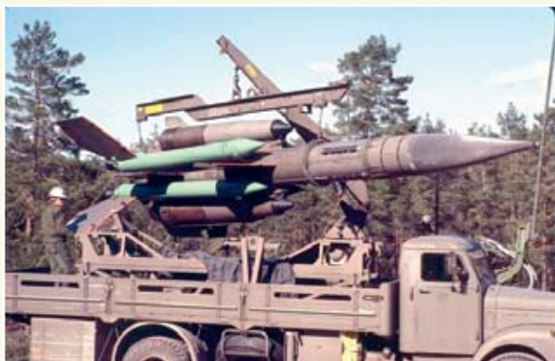
Roboten körs ner i laddläge (vågrätt) och lyft från lavetten till robotlastbilen med en speciellt för ändamålet monterad kran.
