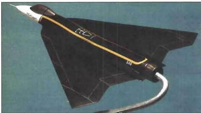
Här Lockheed Martins modellförslag till stjärtlöst flygplan (baserat på NASA:s F-16XL). Naturligtvis med vektoriserad dragkraft. Fena och stabilisator ersatta bl a med rörliga ving-spetsar och framkants klaffar.
