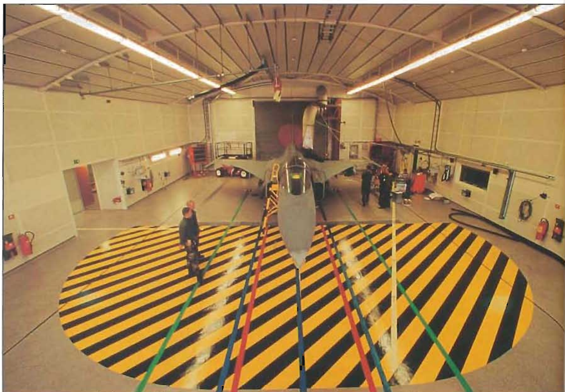
Bilderna t h (sid 24 och 25): JAS 39 Gripen under bullerprov i inomhusanläggning.
