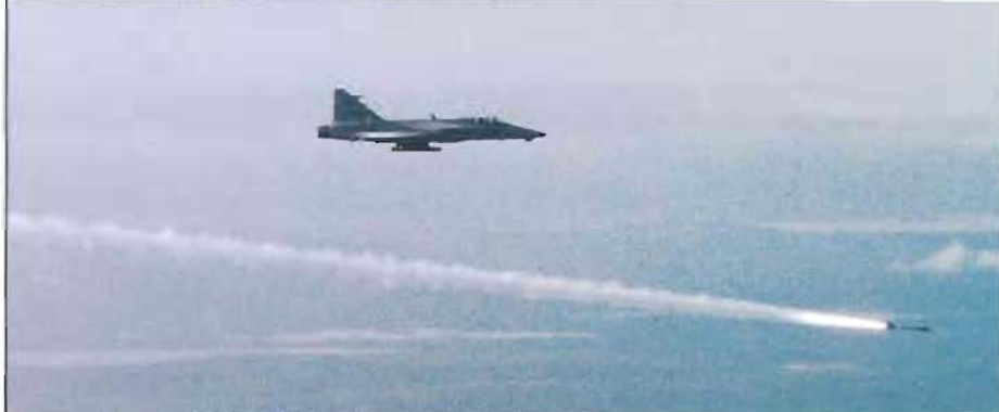
JAS 39 Gripen under skjutprov med jaktroboten Sidewinder (Rb 74). IR-robot utan svängprestanda.
