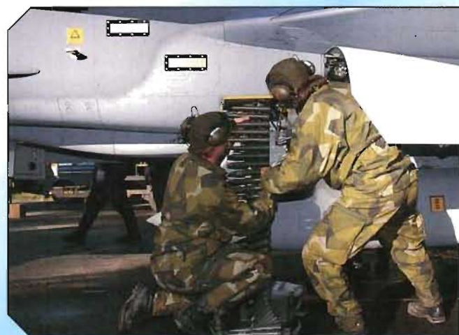
Gripens automatkanon laddas av klargöringstroppen.
