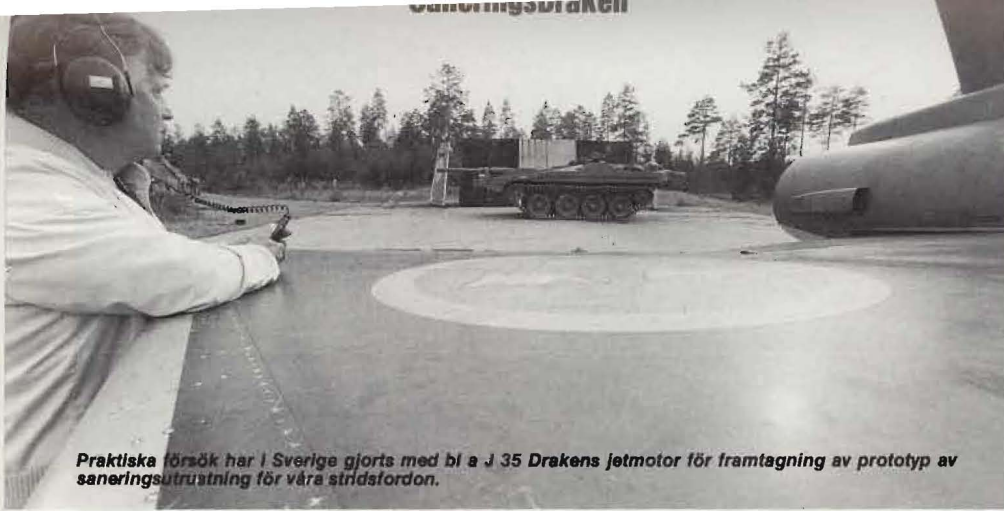
... inom WP Sociala saneringsfordon för bl a artillerivagnar finns i SSSR (MS-65) och, som har TZ-74 i Tjeckoslovakien & DDR. En ordonsburen jetmotor blåser tent/sanerare stridsfordon från kända stridsmedel.
