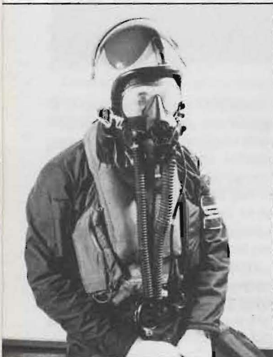
ABC-skyddsutrustning för flygförare är under framtagning för FV. Dräktproven görs av FMV-prov och FÖA. Ovan ses en brittisk dräkt (kolfiberdräkt under flygoverallen, gummi-huva under hjälmen, gummi-/plastunderhandskar + ABC-hjälm).
