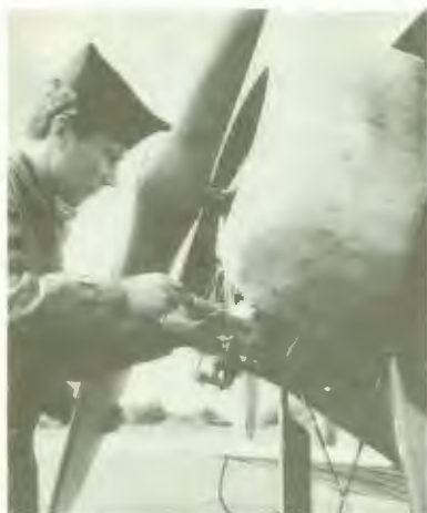
En mekaniker snapsar motorn med en injektionspruta m/jättelik.
