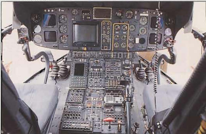
HKP 10:ans cockpit uppvisar största modernitet. Nu kan andre piloten bistå förste piloten helt, medan operatören sköter navigationen från en datapanel med kommunikationstablå, radar och inprogrammerad kartbild och färdlinje.
