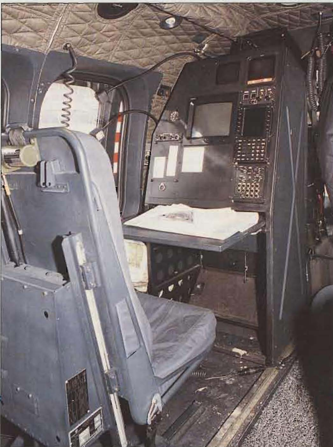
HKP 10:ans cockpit uppvisar största modernitet. Nu kan andre piloten bistå förste piloten helt, medan operatören sköter navigationen från en datapanel med kommunikationstablå, radar och inprogrammerad kartbild och färdlinje.
