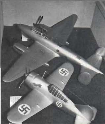
Ovan: A) Petljakov Pe-2, ryskbyggt bomb/attackfpl. Två 12-cylindriga Klimov VK-105-motorer om 1.100 hk. Byggstart —40. B) Brewster Buffalo 239 (BW-367). 44 USA-köpta surplus-fpl. Sammansattes (tillsammans med 35 Fiat G.50) i Trollhättan. Motor: Wright Cyclone R-1820-G-5 om 1.100 hk.
