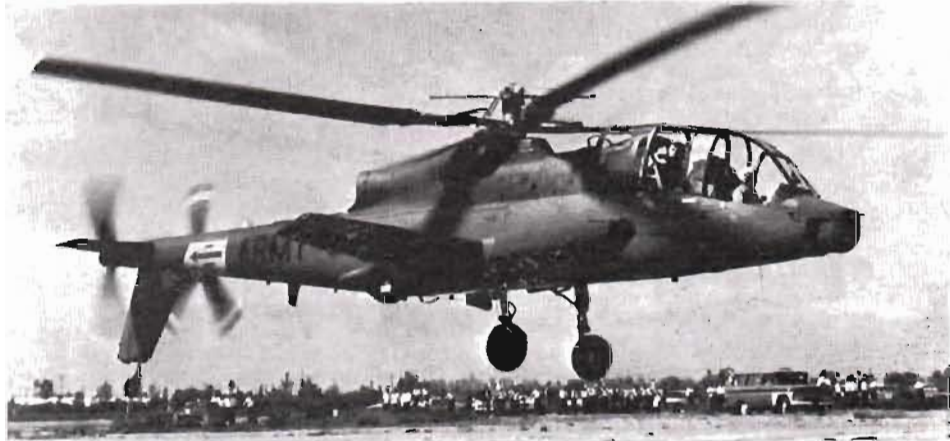
Fig: 15 ■ Amerikanska arméns nya attackhelikopter: rotorplanet Lockheed AH-56A "Cheyenne". Flyger med en hastighet av 400 km/tim. Tjänstevikt 7,7 ton, räckvidd 1.400 km. "Cheyenne" kan stiga till över 8.000 m höjd. Bevapning sex raketer eller mål-sökande robotar, en halvautomatisk 6-pipig kulspjut och en 30 mm automatkanon.
