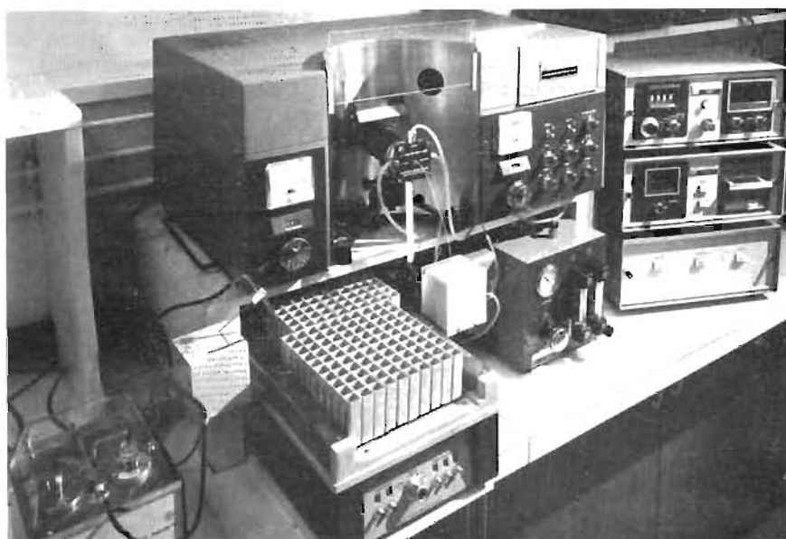
Fig. 11 Detta är en AA (Perkin-Elmer), med de automatiktillsatser som skulle kunna göra det möjligt för teamet på Materiallaboratoriet att analysera ca hundratalet oljeprov per dag – mot dagens ca 30. Den mellersta komponenten av de tre på varandra längst till höger är redan på väg att inköpas. Det är en s k DCR-1 Digital Concentration Readout.
