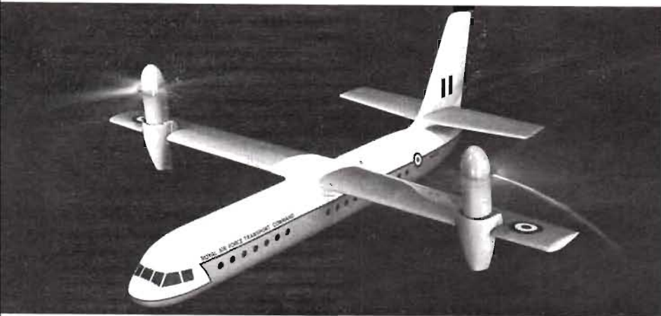
Fig: 10 ● Westland WE-02, England. "Tilt rotor" - VTOL - helikopterflygplan som tar 80 passagerare. Maxfart 610 km/tim. Projektöringen av WE-02 har skapat en hel del problem och därför har man för att lättare komma till rätta med dessa bl a företagit vindtunnelprov för en mindre typ, WE-01, som skall kunna ta sex personer och prestera en maxfart av 460 km/tim.
