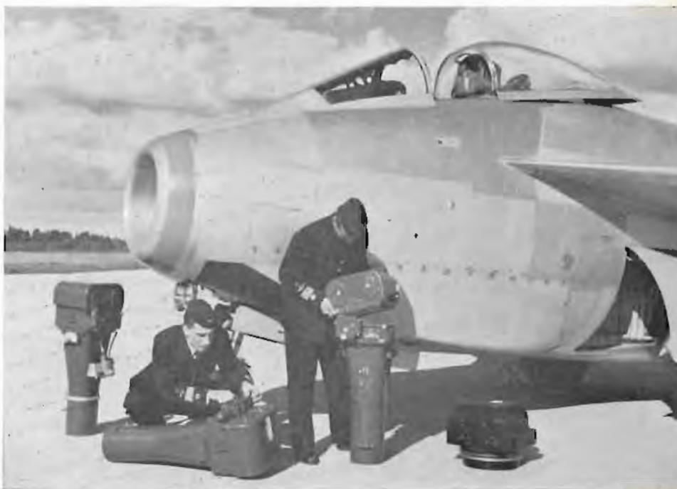
▼ S 29 C — spaningsversionen. Mest påtagliga yttre skillnaden var det låga nospartiet, där sju kameror fanns installerade.
