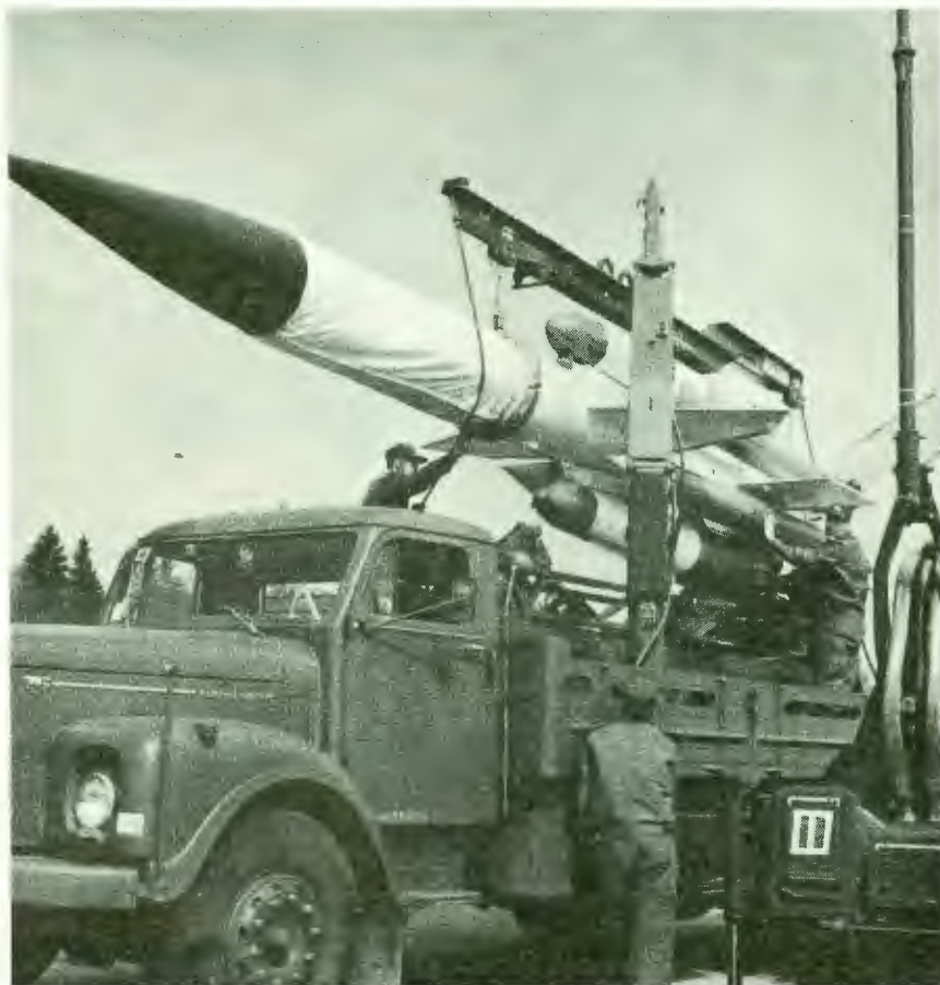
Speciella hydrauliska lyftkranar medger snabb i- och urlastning på de lastbilar som bär RB 68. Förbanden får därmed en hög transportberedskap, vilket också med all tydlighet visades vid robotveckan på F8. Förbandets gruppering under marsch intresserade ej minst TV och utländsk press.
