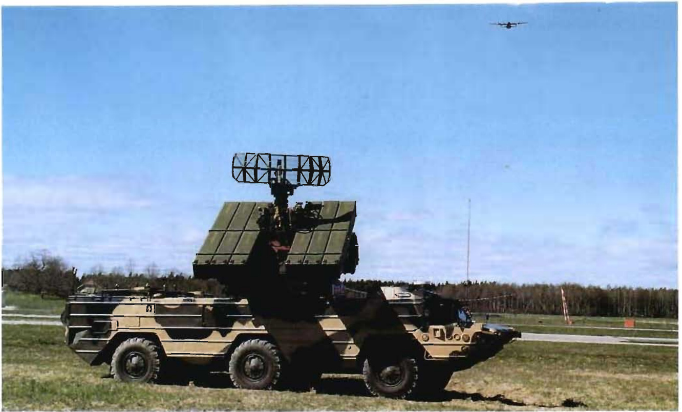
Det ryska luftvärnssystemet SA-8 Gecko ryms i ett amfibiefordon. På de enheter av denna typ som finns i Tyskland är själva vapendelen borta, men radarsystemet fungerar.
