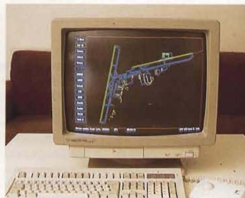
Det nya ledningssystemet har så god upplösning att flygplanen även kan ledas på marken. Samma information finns i flygplanen.
