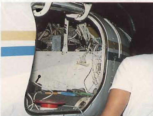
Flygplanet modifieras här så att styrdata kan överföras från satellitnavigering till styrautomat och HSI.
