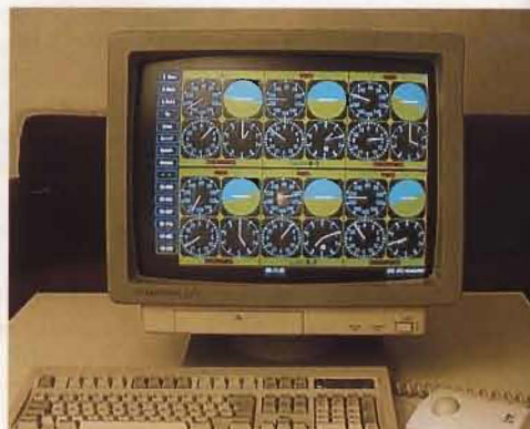
För att prova ledningssystemet och att träna trafikledare har man utvecklat en simulator. Simulatorn är speciell genom att en pilot kan styra upp till sex flygplan samtidigt. Detta innebär att mycket flygtrafik kan genereras med några få piloter. Simulatorn innehåller sex autopiloter, detta för att avlasta flygföraren.
