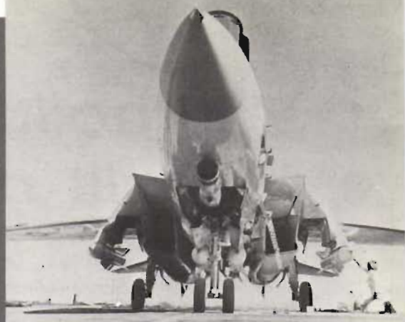
Ovan: US Navy:s F-14 'Tomcat' med 4 jaktrobotar av typ PHOENIX, som är avsedd för bekämpning av luftmål på långa avstånd. — Nedan: En av Israels FV (IAF) förarlösa (Remotely Piloted Vehicle = RPV) typ, Teledyne Ryan Model 147 'Firebee'. Israel utnyttjade dylka nya farkoster under Oktober-kriget för spaningsuppdrag över Egypten och Syrien för fotografiering av flyg- och rb-baser + truppkoncentrationer. Ett antal blev dock nedskjutna. Köpet av RPV nödvändiggjordes sedan flera spanings F-4:or gått förlorade 1969—70.
