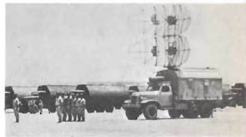
● Ovan: Spaningsradarn till ett SA-3-batteri. I bakgrunden hopfällbara pontonbroar av typ PMP. Luftförsvarets verkan kan reduceras antingen genom direkt bekämpning eller med insats av telemotmedel, vilka främst riktar sig mot luftförsvarets radar-komponenter. — Nedan: En stridsvagn ur 4:e egyptiska pansardivisionen öster om Quantara i Sinai, utslagen sedan angrepp utförts med ROCK-EYE multipelbomber. Med attack-rb och multipelvapen är det numer stridsekonomiskt att bekämpa enstaka fordon.
