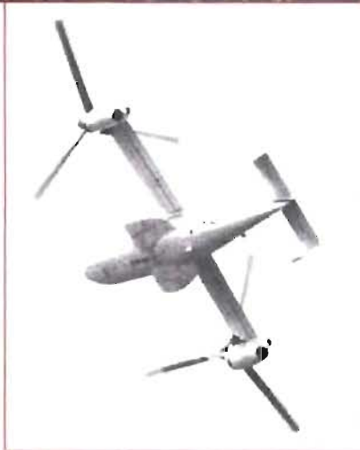
Bill XV-15 är ett flygplan som kan vrida sina vingspetsar för att fungera som helikopter. Detta gör att det kan flyga både som ett flygplan och som en helikopter. Det är ett av de mest avancerade flygplanen som någonsin byggts. Det har en mycket hög hastighet och kan flyga mycket lågt över marken. Det är också mycket tyst och kan flyga i tät bebyggelse. Detta gör att det är ett mycket användbart flygplan. Det har också en mycket lång livslängd och kan flyga många timmar utan att behöva repareras. Detta gör att det är ett mycket kostnadseffektivt flygplan. Det är också mycket enkelt att flyga och kan användas av både professionella piloter och amatörer. Detta gör att det är ett mycket populärt flygplan. Det har också en mycket hög säkerhetsnivå och kan flyga i mycket svåra väderförhållanden. Detta gör att det är ett mycket pålitligt flygplan. Det är också mycket flexibelt och kan användas för många olika ändamål. Detta gör att det är ett mycket användbart flygplan. Det har också en mycket hög kapacitet och kan flyga med många passagerare. Detta gör att det är ett mycket praktiskt flygplan. Det är också mycket ekonomiskt och kan flyga till låga kostnader. Detta gör att det är ett mycket attraktivt flygplan. Det har också en mycket hög bränsleeffektivitet och kan flyga mycket långt på en full tank. Detta gör att det är ett mycket effektivt flygplan. Det är också mycket miljövänligt och kan flyga på biobränsle. Detta gör att det är ett mycket hållbart flygplan. Det har också en mycket hög teknisk nivå och kan flyga mycket snabbt. Detta gör att det är ett mycket avancerat flygplan. Det är också mycket lätt att underhålla och kan repareras snabbt. Detta gör att det är ett mycket praktiskt flygplan. Det har också en mycket hög tillförlitlighet och kan flyga många timmar utan att behöva stoppas. Detta gör att det är ett mycket pålitligt flygplan. Det är också mycket enkelt att flyga och kan användas av både professionella piloter och amatörer. Detta gör att det är ett mycket populärt flygplan. Det har också en mycket hög säkerhetsnivå och kan flyga i mycket svåra väderförhållanden. Detta gör att det är ett mycket pålitligt flygplan. Det är också mycket flexibelt och kan användas för många olika ändamål. Detta gör att det är ett mycket användbart flygplan. Det har också en mycket hög kapacitet och kan flyga med många passagerare. Detta gör att det är ett mycket praktiskt flygplan. Det är också mycket ekonomiskt och kan flyga till låga kostnader. Detta gör att det är ett mycket attraktivt flygplan. Det har också en mycket hög bränsleeffektivitet och kan flyga mycket långt på en full tank. Detta gör att det är ett mycket effektivt flygplan. Det är också mycket miljövänligt och kan flyga på biobränsle. Detta gör att det är ett mycket hållbart flygplan. Det har också en mycket hög teknisk nivå och kan flyga mycket snabbt. Detta gör att det är ett mycket avancerat flygplan. Det är också mycket lätt att underhålla och kan repareras snabbt. Detta gör att det är ett mycket praktiskt flygplan. Det har också en mycket hög tillförlitlighet och kan flyga många timmar utan att behöva stoppas. Detta gör att det är ett mycket pålitligt flygplan. Det är också mycket enkelt att flyga och kan användas av både professionella piloter och amatörer. Detta gör att det är ett mycket populärt flygplan.
