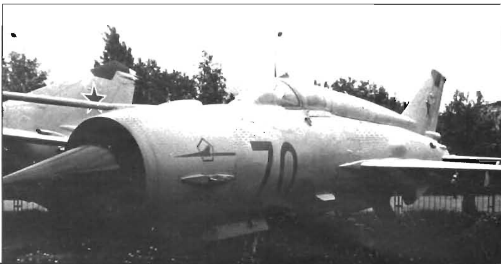
Ovan: Museets F-version av MiG-21 'Fishbed' har gångjärn på huvens bakkant, vilket indikerar att huvan på detta förserieplan fälldes bakåt. Denna huvmekanism var dock inte bra, och ersattes på serieexemplaren med annan typlösning.
