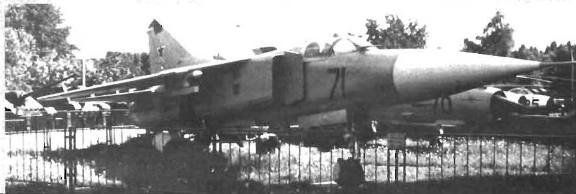
T v: MiG-23 'Flogger A', troligen en prototyp eller ett försöksflygplan. Bär standardfenan av 1 dag men har tidig versions kropp och vingar (bl a utan det karaktäristiska 'hacket' vid vridinfästningspunkten på ytterdelsvingen).
