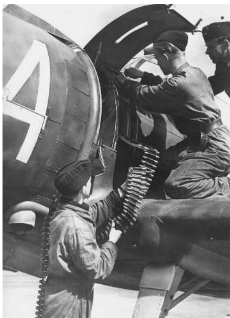
Laddning av kulsprutorna på J 20. Genom problem med synkroniseringen vapen/propeller, blev eldhastigheten med tiden mycket låg.
