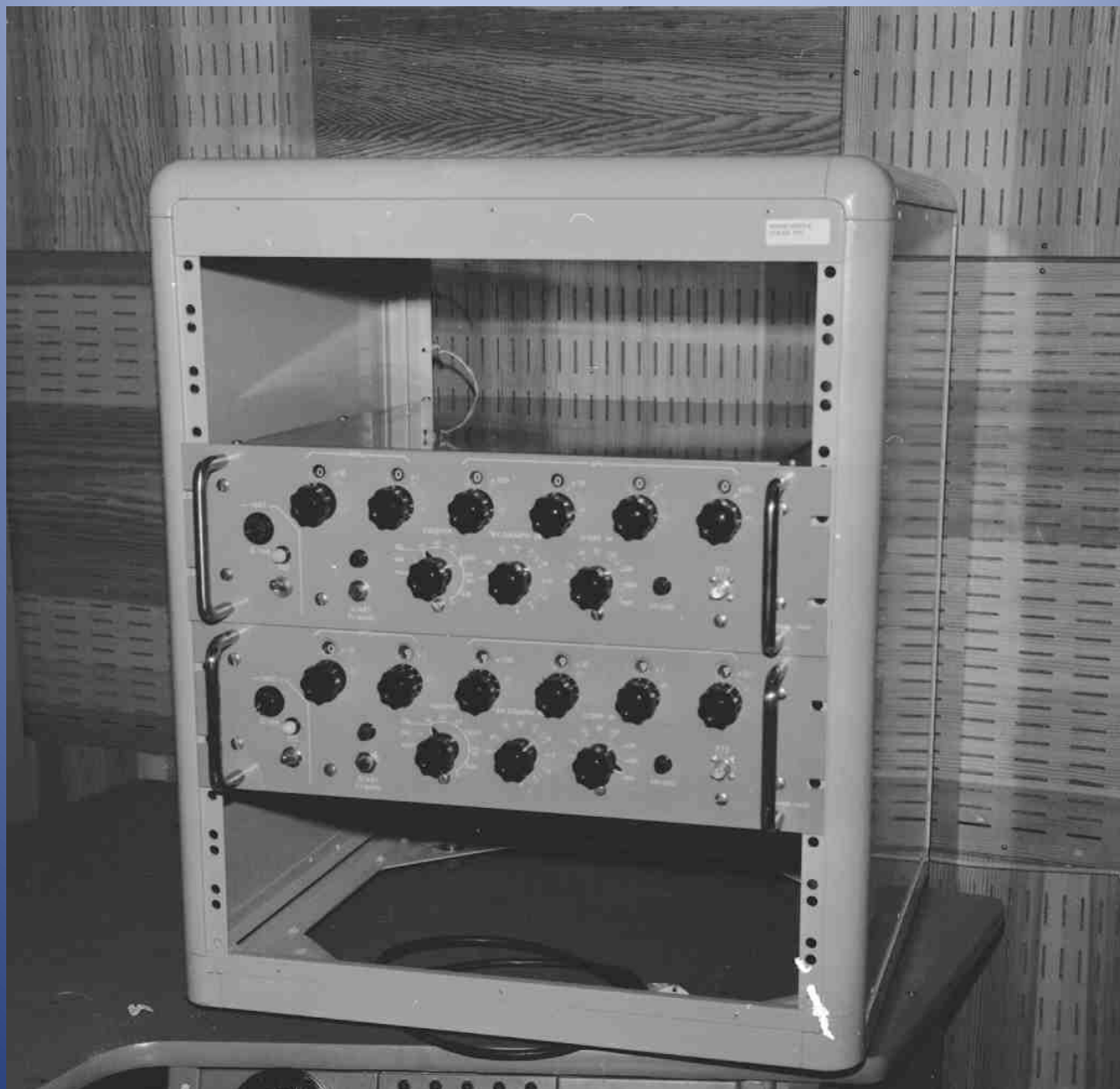
Manöverutrustningar för sändare CT 1000, placerade i mottagarexpeditionen för att styra sändare i annex.
