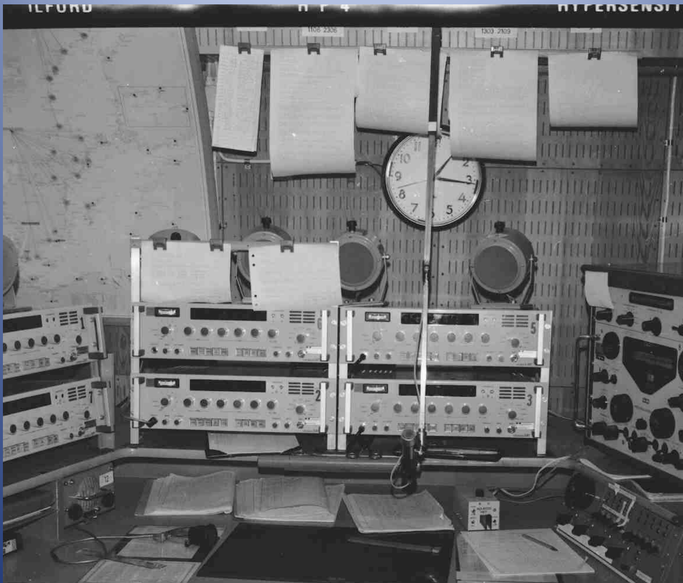
Tingstade radio expeditionsplats på 1970-talet. Moderna KV-mottagare av typen 722 från SRT Till höger LV-mottagare typ Ra 117(Racal)
