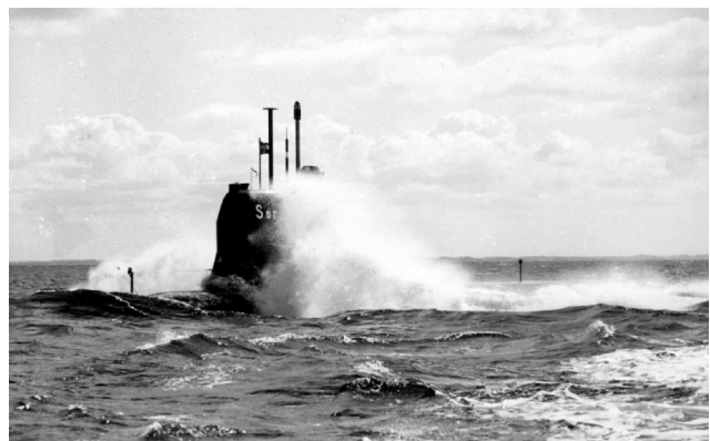
Sjöormen – kortvågsantennen har den horisontella plattan (Bengt Rasin)
