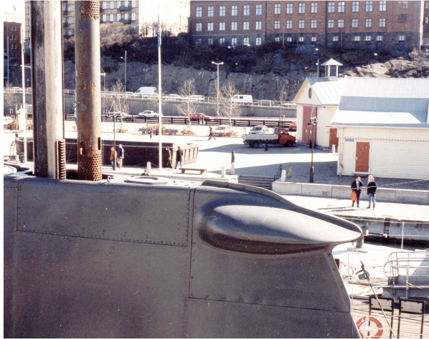
Långvågsantennen med två korslagda ferritspolar (i radomen) på Nordkaparen som är bevarad på Marintekniskt centrum i Göteborg
