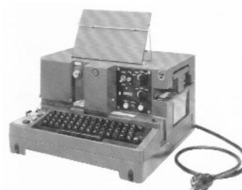
Krypteringsapparat 210 används för lokal (off line) kryptering och dekryptering av meddelanden. Den används huvudsakligen för fjärrskriftmeddelanden.
