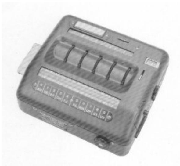
Krypteringsapparat 301 är en mekanisk krypteringsapparat för manuell kryptering och dekryptering av skrivna meddelanden.
