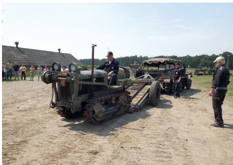
En tre-tons bandtraktor under avlastning från sin speciella tippkärren av halvbandtraktor.
