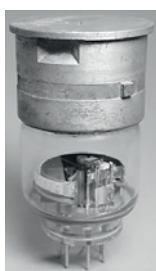
Bild 1. "Kärnan" i ER I, sändartrioden Telefunken LS 30 ("L" står för Luftwaffe och "S" betyder att det är ett sändarrör).
