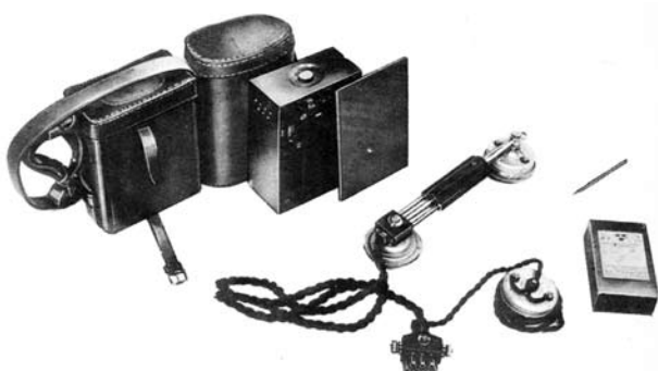
Telefonapparat m/12, Tc 90170. Längd 250 mm, bredd 100 mm, höjd 180 mm.
