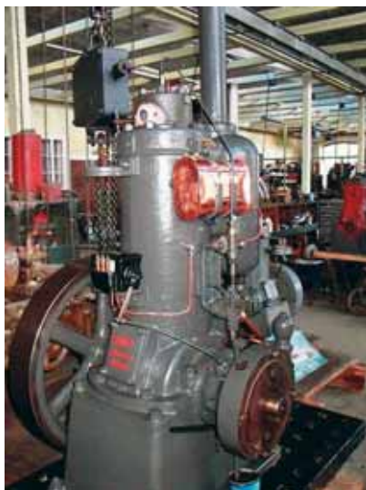
Nästan färdigrenoverad tändkulemotor.
